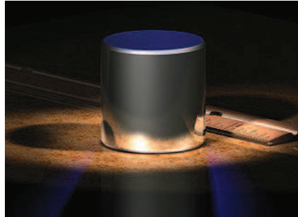
Fig. 1: computer-gegenereerde afbeelding van de internationale standaard kilogram, een cilinder bestaande uit een platina-iridium legering met 39,17 mm diameter en hoogte, met afgeronde randen om verwerking te minimaliseren. De standaard kilogram bevindt zich in het Bureau International des Poids et Mesures te Sèvres nabij Genève.
